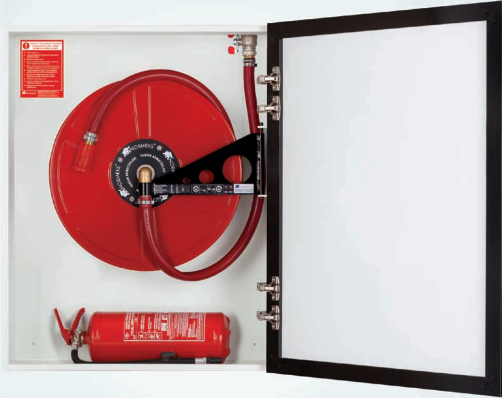
NORMEKS® model GT12-YT-CK, alüminyum cam kapaklı, özel menteşeli gömme montajlı bir dolaptır. Makara 180° asılı bir desteğe sabitlenmiş ve dolabın sağ tarafına monte edilmiştir.
